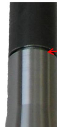
ガイドロッドとカップリングを正常に接続すると少し隙間があります。(1.5~3.5mm)
