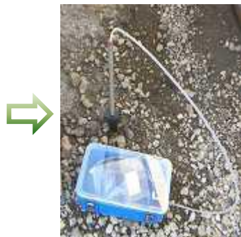
保護管セット ガス採取管挿入 土壤ガス採取器接続
