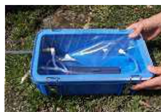
ポンプ電源を入れフタを閉める。
