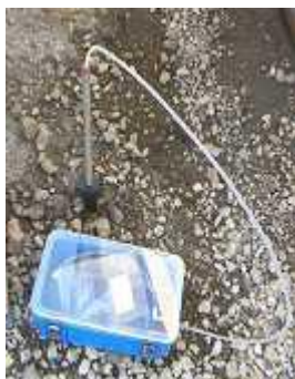
保護管セット ガス採取管挿入 土壤ガス採取器接続
