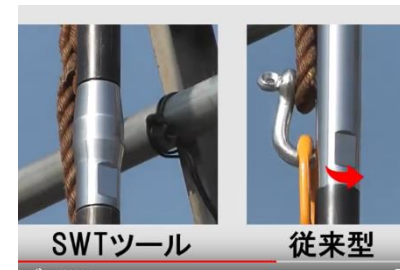
打撃による緩みが発生してガイドロッドが回転 (従来型)
