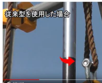
打撃による緩みが発生してガイドロッドが回転 (従来型)
